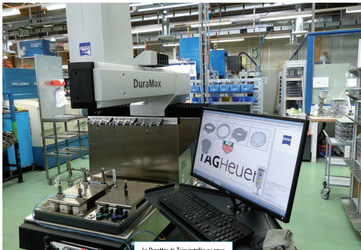
La DuraMax de Zeiss installée au cœur de l'atelier de l'entreprise TAG Heuer. La machine a notamment été choisie pour la stabilité thermique des mesures.
