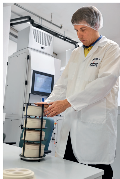
Les supports et portes-capsules sont fabriqués avec un plastique spécial, qui n'influence pas le processus de scanning. Ils ont été développés ensemble avec ZEISS.
