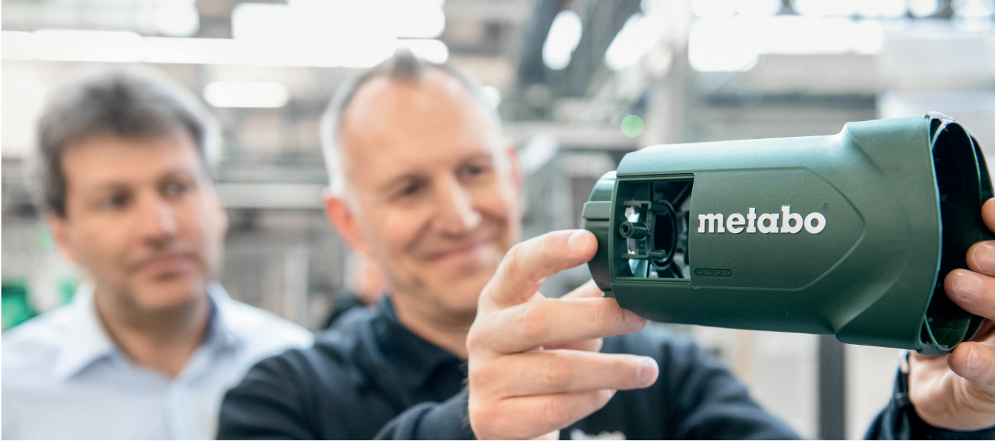
U. Forscher contrôle le corps (carter moteur) d'une disqueuse, pièce moulée qui est également fabriquée à Nürtingen.
